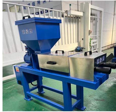
水泥研磨過濾機 回收再利用 41%
