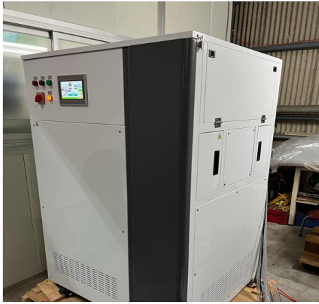
低溫真空蒸餾機 回收再利用 80~85%
